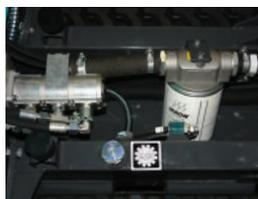
Réservoir d'huile hydraulique incorporé au châssis
