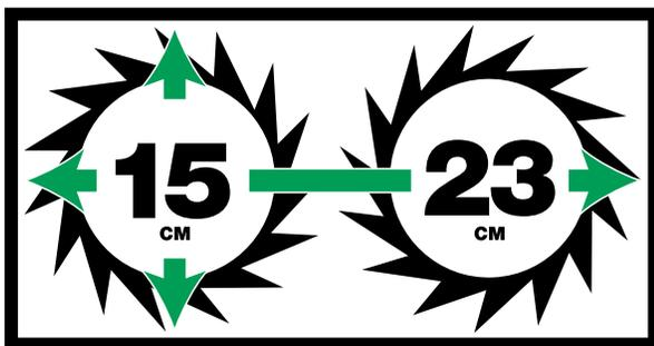
L'ouverture de 16cm en hauteur et 23 cm en largeur permet d'alimenter tout type de branche quelle que soit sa morphologie sans besoin la plupart du temps de tailler au préalable à la tronçonneuse, ce qui représente un gain de temps considérable.
