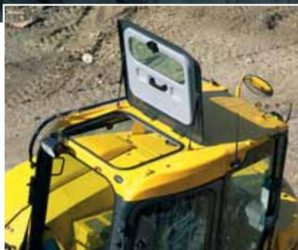
Toit ouvrant pour la visibilité au-dessus de la cabine
