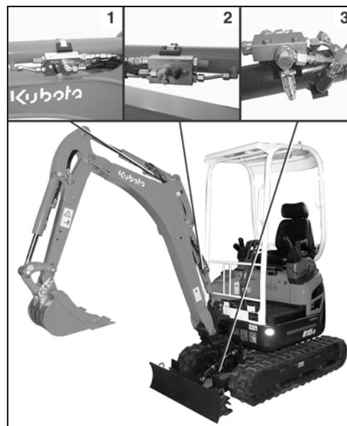
Départ usine, le clapet de sécurité (1) a été taré pour la pelleuse respective et plombé (2).
