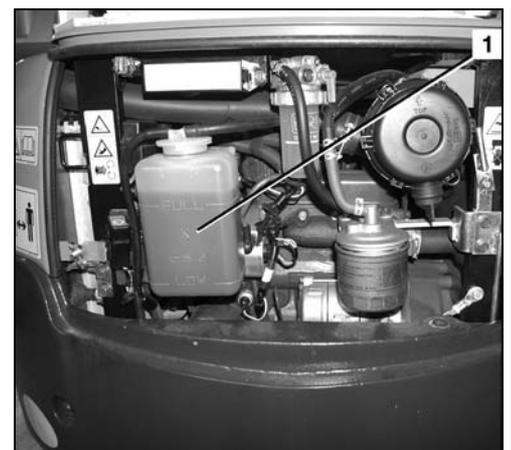
Si le vase d'expansion avait été complètement vidé, contrôler le niveau du liquide de refroidissement dans le radiateur.
