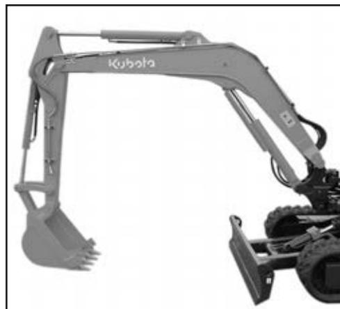
Contrôler le niveau d'huile à la jauge d'huile (1). Le niveau d'huile doit atteindre le milieu de la jauge d'huile. Avant de faire l'appoint, si nécessaire, contrôler encore une fois la position exacte des vérins hydrauliques, voir Appoint/vidange d'huile hydraulique (page 121).
