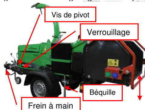
Fig 4.3 Tête d'attelage réglable et béquille
