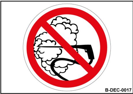
Plaque d'interdiction - Nettoyage à haute pression
