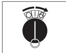
2. Après avoir démarré le moteur, tourner le levier de starter progressivement pour ouvrir les gaz et le maintenir sur la position d'ouverture complète. Ne pas ouvrir immédiatement à fond le levier de starter lorsque le moteur est froid ou que la température ambiante est basse car le moteur risquerait de caler. Laisser le moteur chauffer pendant quelques minutes sans charge.
